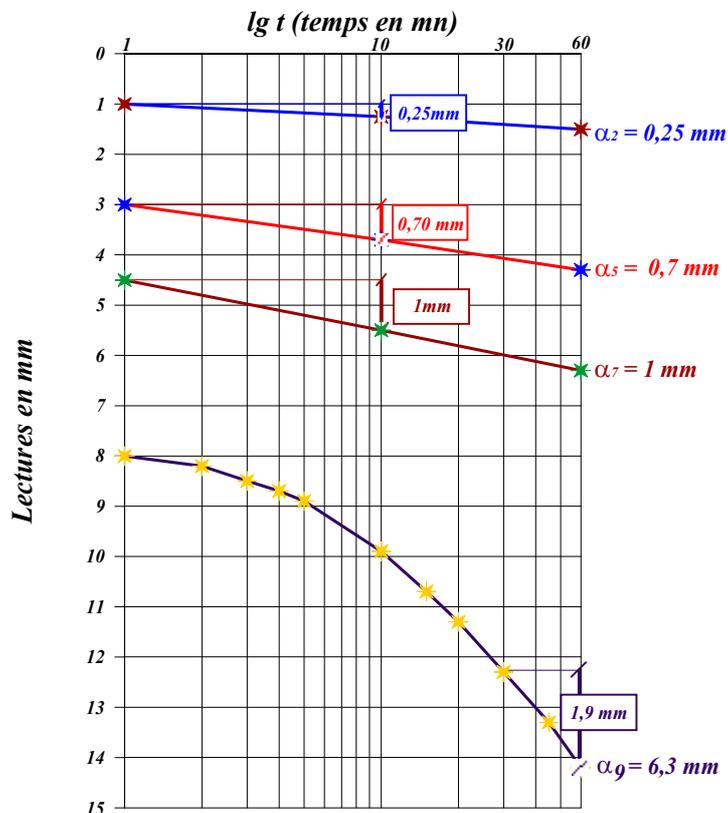
Fig.18.2a Droites et courbes de fluage des 2<sup>ème</sup>, 5<sup>ème</sup>, 7<sup>ème</sup> et 9<sup>ème</sup> palier
