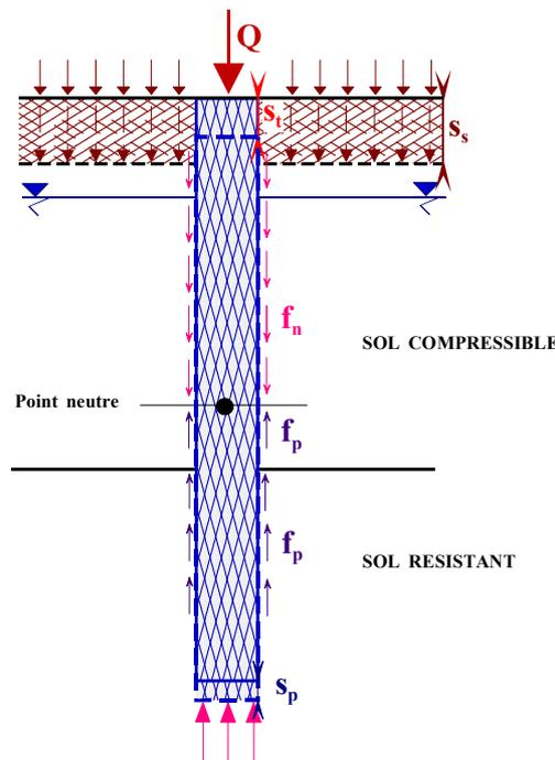
Fig.18.7 Mécanismes du frottement latéral positif et négatif
