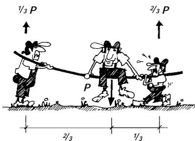
Si la l. d'a. de la résultante des actions ne passe pas à mi-distance des appuis, l'appui le plus proche de la l. d'a. reçoit la plus grande partie de la charge. L'intensité des forces de réaction dans les appuis n'est plus égale.
