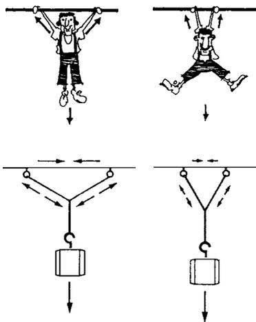
Les systèmes articulés auxquels sont suspendues des charges se comportent de façon identique. Pour un même chargement, plus l'inclinaison des membrures sur l'horizontale est forte, plus les forces induites sont élevées.
