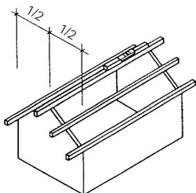
La panne faîtière doit être horizontale, parfaitement centrée sur les pignons et parallèle aux sablières. La hauteur de la panne faîtière est déterminée par la pente et la longueur du rampant. Les tableaux de l'annexe 1 permettent de calculer la hauteur de la panne faîtière, par rapport aux sablières.
