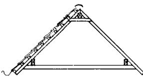
Charges constantes et immobiles. Dans la plupart des cas, le poids propre (effet de la gravité qui s'exerce sur la masse des matériaux) est la seule charge appliquée en permanence.
