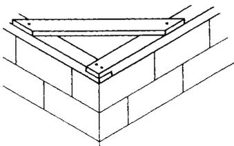
Si la sablière est utilisée comme chaînage, elle doit faire le tour de la construction et les joints d'angles doivent être solides (c). Pour les constructions très longues, on pose aussi une sablière sur les murs intérieurs, de façon à relier fermement les sablières des deux murs extérieurs (d).
