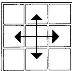
On peut couvrir un espace carré, ou presque carré, avec un réseau de membrures croisées qui portent dans les deux directions du plan horizontal. Dans la construction en béton, le «plancher gauffré» illustre bien cette solution. Un réseau d'armature parcourt des canaux croisés. Après bétonnage, on obtient un réseau de poutres croisées. Différents types d'éléments préfabriqués en béton (voussoirs, poutres, prédalles, etc.) facilitent la mise en oeuvre de ce type de solution.
