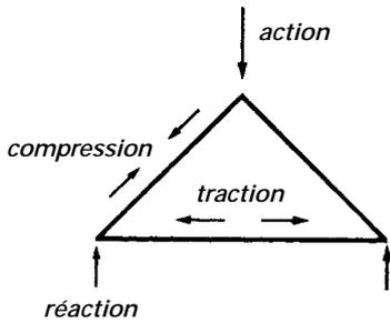
Les charges appliquées sur une ferme induisent, dans les membrures, des contraintes de compression ou de traction.
