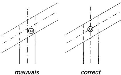
Il est donc important de soigner la conception et la réalisation des assemblages pour aligner les forces de compression sur l'axe longitudinal des membrures comprimées.
