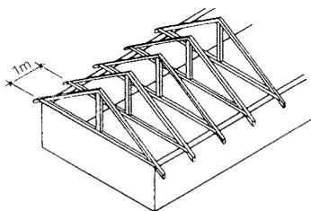
Au lieu d'une construction ferme-panne-chevron, chaque paire de chevrons est reliée par un entrait (horizontal) et un poinçon (vertical). Cet assemblage se comporte comme une ferme.
