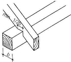
Les chevrons sont assemblés à la sablière et aux pannes par un embrèvement à grain d'orge. Correctement exécuté, la largeur de l'embrèvement atteint la moitié de la largeur de son point d'appui.
