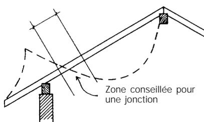
Il est préférable d'utiliser des chevrons d'une seule pièce. Lorsque ce n'est pas possible, on réalise la jonction à l'endroit où le moment de flexion est le plus faible (voir croquis ci-contre). Pour ce type de jonction, on recommande d'utiliser des assemblages à éclisses.
