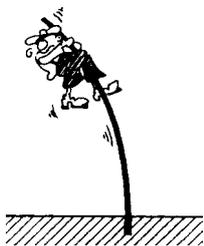
Pour une charge donnée, le risque de flambage dépend de la longueur de la pièce comprimée, de sa section et du degré de liberté (possibilité de mouvement) de ses extrémités.
