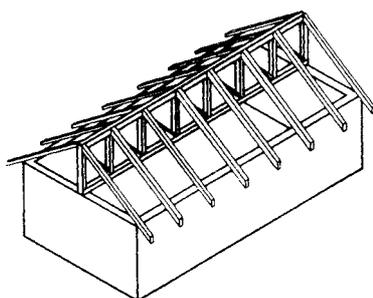
Dans certains cas, il est plus économique de poser une poutre triangulée dans le sens de la plus longue portée. Cela permet de réduire la charpente primaire à un seul élément, encombrant et lourd il est vrai.
