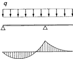
Dans le cas d'une poutre avec porte-à-faux, portant une charge uniformément répartie, entre les appuis le diagramme du moment fléchissant a une allure semblable au cas précédent, tandis que sur la travée en porte-à-faux le moment fléchissant est négatif.
