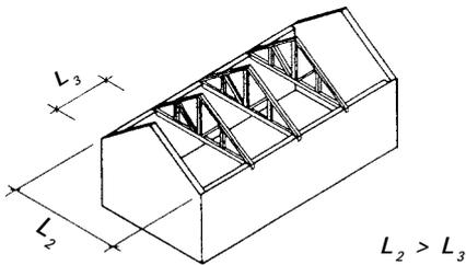
Diviser la plus grande portée avec un ou plusieurs élément(s), par exemple des poutres ou des fermes, franchissant la plus petite portée (L2). Le nombre d'éléments dépend de la longueur de la grande portée et est tel que la longueur de la nouvelle portée L3 est significativement plus petite que L2. Ces éléments constituent le niveau de charpente primaire.
