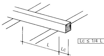
Pour éviter d'induire un moment de flexion trop important au droit de l'appui sur les rampants des pignons extérieurs, le porte-à-faux ( $L_c$ ) du débordement de toiture ne doit pas dépasser 25 % de la portée normale ( $L$ ).
