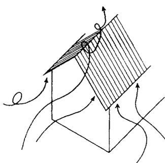
Dans la plupart des régions, c'est le vent qui induit la sollicitation la plus critique. Des vents violents peuvent causer des dégâts considérables, si la toiture n'est pas bien construite et / ou solidement ancrée au bâtiment.
