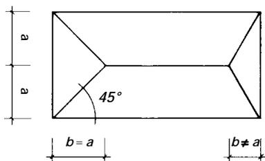
Si les pentes sont égales, alors la projection en plan de l'arêtier dessine un angle de 45° et  $a = b$ Si les pentes sont différentes, alors  $a \neq b$
