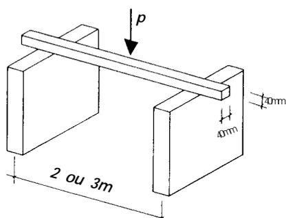
On peut déterminer la charge de rupture à l'aide d'un test simple.
