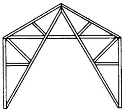
Ils permettent de franchir de grandes portées sans appui intermédiaire (hangars, etc.). Les portiques reposent directement sur les fondations et supportent le toit ainsi que le bardage.
