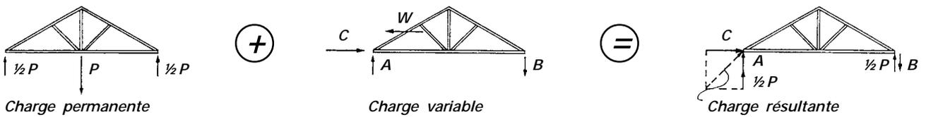
*Il est fondamental de comprendre que toutes les forces agissant sur la toiture, qu'elles soient horizontales ou verticales, sont transférées via les murs, jusqu'aux fondations, et ceci quelle que soit la géométrie de la charpente et des murs.* La conception des murs et des fondations doit donc aussi tenir compte des forces agissant sur la toiture (voir [chapitre 4.2.1](#)).
