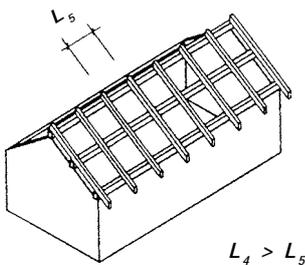
Avec la pose d'un niveau de charpente tertiaire (chevrons) on réduit encore la portée (L5).
