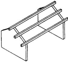
Les pannes et pannes faitières constituent, selon le cas, la charpente primaire (pas de fermes) ou la charpente secondaire (si posées sur des fermes). Elles sont posées horizontalement et portent les chevrons (voir aussi [point 4.1](#)).
