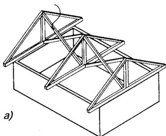
Contreventer consiste à fixer la position d'un point instable en le reliant à une butée, par une, ou plusieurs membrures. Selon le type de charpente, les membrures de contreventement sont fixées aux fermes (a) ou aux chevrons (b).
