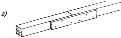
Résistance limitée et répartition inégale des contraintes de cisaillement dans le joint.
