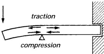
L'application de la force verticale provoque un moment de rotation. Celui-ci est équilibré par l'effort de traction qui agit dans la partie tendue de la matière et par l'effort de compression qui agit dans la partie comprimée de la matière.
