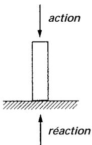
Il s'agit de l'effort interne qui agit dans une membrure comprimée: par exemple dans une colonne sur laquelle on pose une charge.
