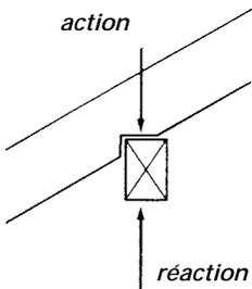
Selon le type de jonction, une action engendre soit une seule force de réaction de sens opposé, soit deux forces de réaction dont la résultante est de sens opposé à l'action.
