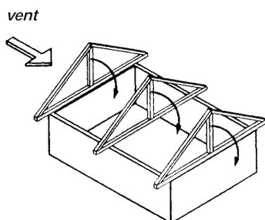
Le contreventement empêche le renversement de la charpente sous l'action des sollicitations horizontales (vent, séisme, etc.) et réduit sa déformation.
