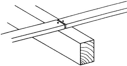
Les assemblages sont exécutés sur des chevrons, par une coupe verticale.
