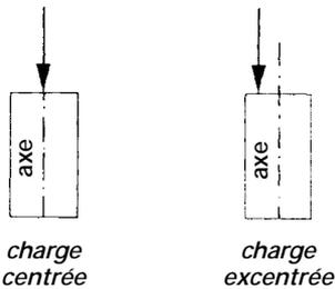
Le point d'application de la charge joue aussi un rôle. Ainsi, le risque de flambement augmente lorsque le point d'application s'éloigne de l'axe longitudinal.
