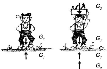
La somme vectorielle des sollicitations (actions et réactions) agissant sur un corps au repos est toujours nulle. Dès lors, à toute action (force) s'exerçant sur un corps au repos, correspond une ou plusieurs forces de réaction produisant une sollicitation de même intensité mais de sens opposé.
