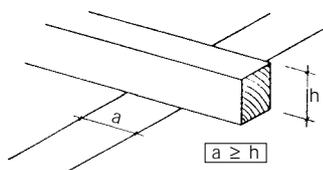
La surface de contact de la panne avec le point d'appui doit être suffisante pour éviter l'écrasement des fibres. Ainsi, on veille à ce que la largeur du point d'appui (a) soit au moins égale à la hauteur de la poutre (b).
