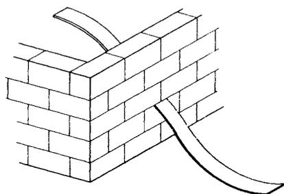
Pour éviter que le vent soulève la toiture, la charpente doit être ancrée aux murs. Des cerclages en acier (fer à béton, bande d'acier, etc.) sont utilisés à cet effet. La profondeur d'ancrage doit être suffisante pour garantir l'efficacité de la mesure (minimum 60 cm). On peut aussi réserver des emplacements dans la maçonnerie permettant de fixer des pièces de bois à l'aide de quincaillerie.
