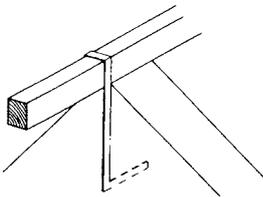
Elles sont posées sur les rampants des pignons extérieurs et parfois intérieurs. Elles sont ancrées à la maçonnerie comme les sablières, ou mieux, à la poutre de chaînage.
