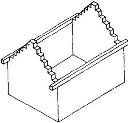
Ces membrures répartissent uniformément, sur le mur, les charges du toit et servent de point d'ancrage aux chevrons ou aux fermes.
