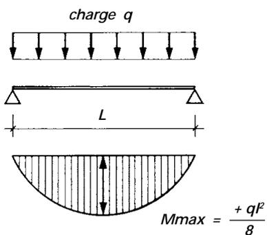
Les efforts internes de compression et de traction sont proportionnels au moment fléchissement de la poutre et inversement proportionnels à l'aire de sa section.
