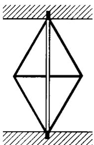
Une triangulation diminuant la longueur libre d'une colonne réduit le risque de flambement.
