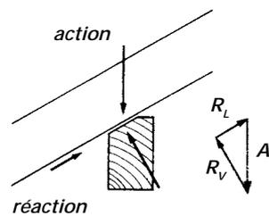
Par temps calme (pas de vent), la jonction «arasement à grain d'orge» n'induit qu'une seule force de réaction, verticale et dirigée vers le haut (opposée à l'action).
