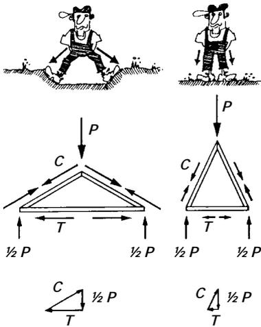
Les membrures de fermes et de systèmes triangulés sont sollicitées par des efforts de compression ou de traction. Pour une même sollicitation extérieure, la valeur de ces forces dépend de la géométrie du système. Elles sont inversement proportionnelles à la pente des versants.
