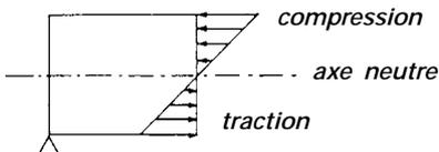
L'intensité des contraintes (traction et compression) est maximale en périphérie et nulle au centre d'une section transversale. L'axe longitudinal, reliant tous les lieux de contrainte nulle, est appelé axe neutre.
