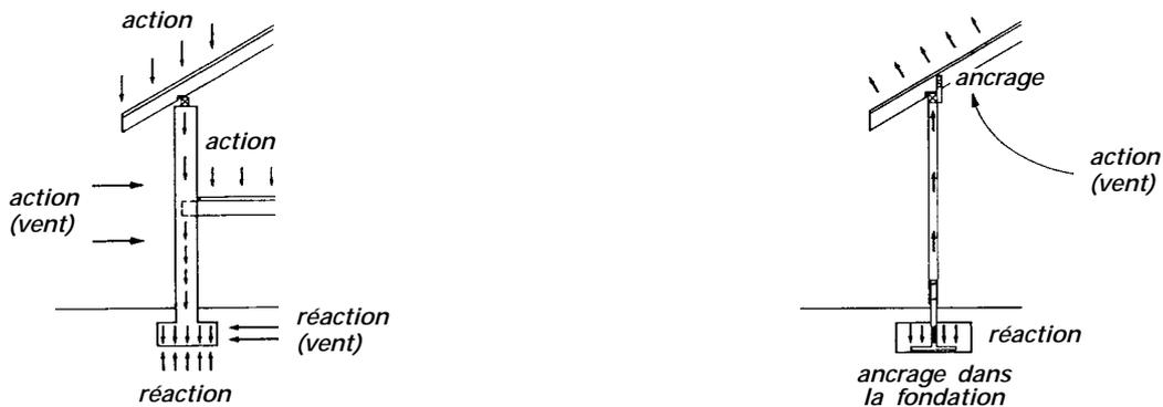
Descente de charges et réactions dues à la combinaison des charges permanentes et du vent, dans le cas d'une toiture lourde
