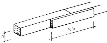
a) La longueur des éclisses doit être supérieure à 5 fois la hauteur des membrures à assembler.
