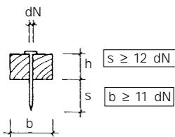
Utiliser des clous suffisamment longs. La profondeur de pénétration des clous dans le chevron doit atteindre au moins 12 fois le diamètre du clou.
