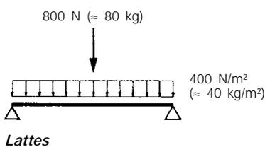
Ces tableaux ont été déterminés pour les cas de charge repris ci-dessous (voir aussi [chapitre 2.3.3](#)). Ces sollicitations correspondent au cas d'une toiture couverte de tuiles TMV ou d'autres matériaux de même poids.
