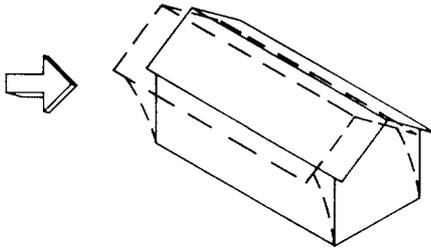
Une ossature aux connections flexibles, mais solides, s'adapte aux déformations temporaires causées par les secousses. Des éléments de couverture de petites dimensions, tels que des tuiles, peuvent être dérangés, mais restent habituellement indemnes, alors que des éléments de grandes dimensions, tels les plaques en amiante-ciment, risquent de se rompre.
