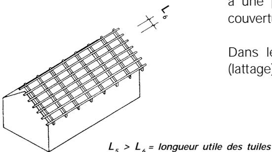
La pose du dernier niveau de charpente (p.ex. lattage) doit conduire à une portée (L6) correspondant à la portée utile du matériau de couverture.
