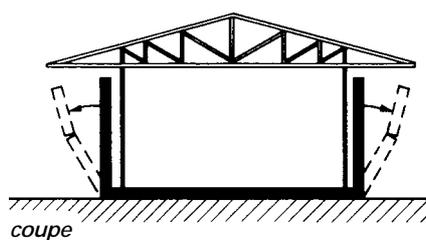
On peut aussi fixer la charpente d'un toit à des supports indépendants des murs. Dès lors, en cas d'écroulement des murs, le toit reste en place.
