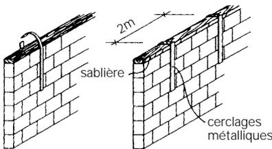
Ces membrures sont ancrées dans les murs pour éviter l'arrachement du toit lorsque des vents violents induisent une dépression.
