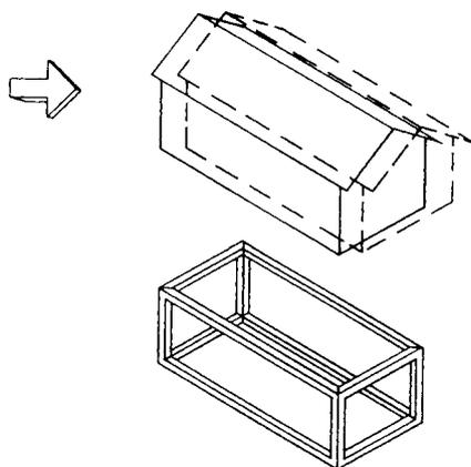
Une autre approche consiste à construire une ossature rigide capable de maintenir sa forme pendant les séismes. Les secousses induisent alors des sollicitations dynamiques considérables.
