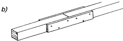
Résistance doublée. Aussi utilisé pour allonger d'autres éléments de charpente tels que chevrons et pannes.
