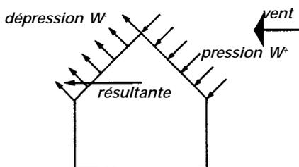
La charge due au vent agit perpendiculairement aux versants. Généralement, elle induit une pression ( $W^+$ ) sur le versant au vent et une dépression ( $W^-$ ) sur le versant sous le vent. La résultante ( $W = W^+ + W^-$ ) est habituellement plus ou moins horizontale (parallèle à la direction du vent).
