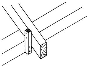
Le vent pouvant induire des efforts tendant à soulever la toiture, il faut attacher solidement les chevrons aux pannes et à la sablière, soit avec des clous, soit avec des tasseaux.
