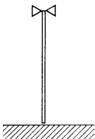
Ainsi, le risque de flambement augmente si la partie supérieure de la colonne est libre et diminue si l'extrémité supérieure est aussi fixée.
