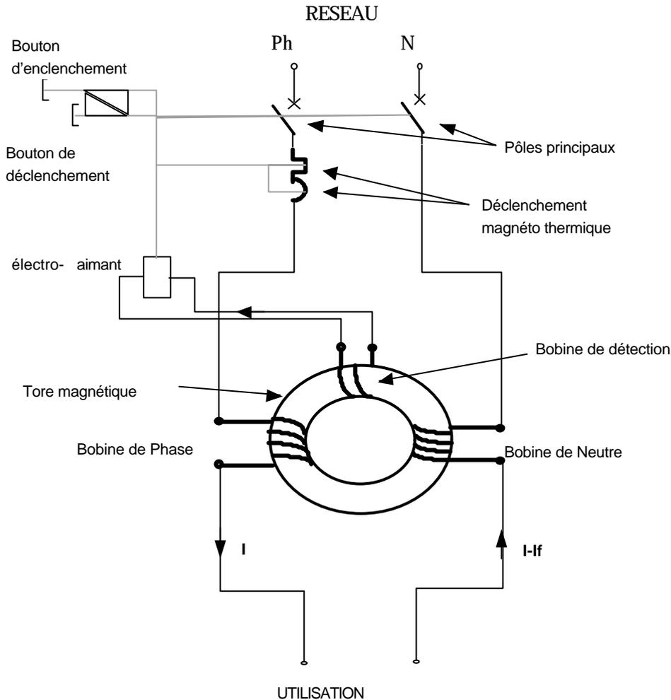
Le système est analogue en triphasé mais comprend quatre bobines sur le tore (**3 phases + neutre**).
