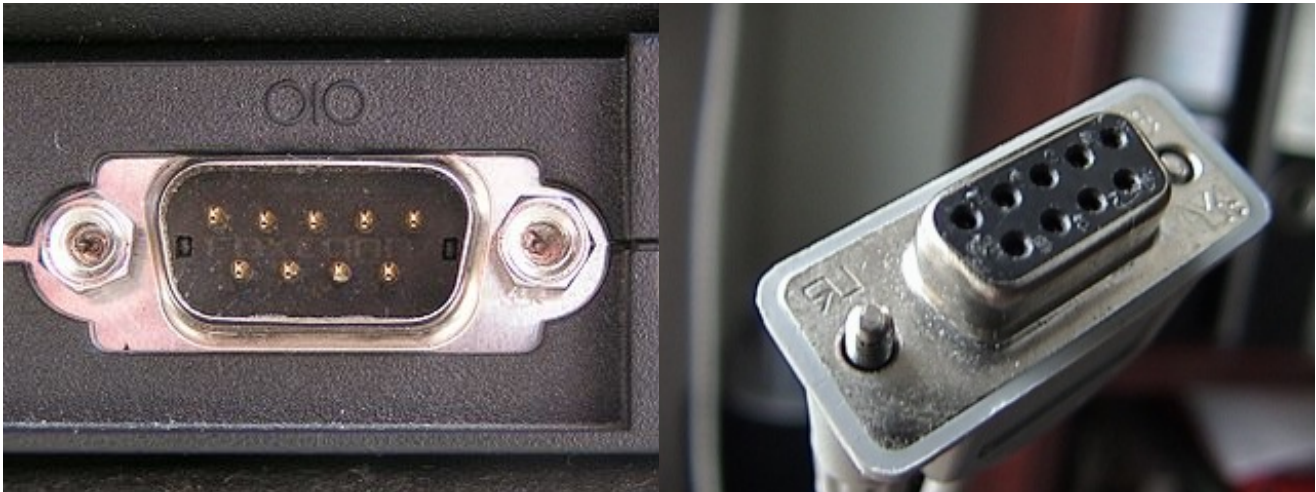
Photos extraites du site Wikipédia - Connecteur DB9 Mâle à gauche ; Femelle à droite
