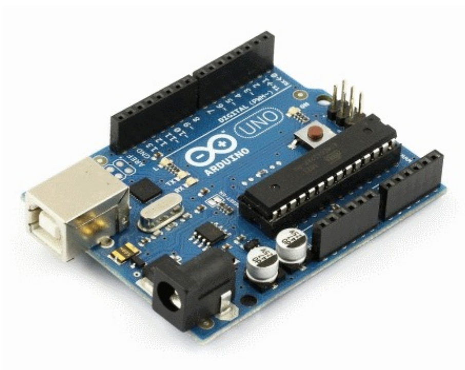
Figure 3 : carte Arduino "Uno" sur laquelle nous allons travailler
