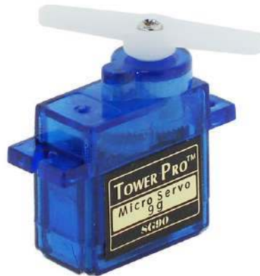
Un servomoteur dit «9 grammes» très répandus dans le monde de l'Arduino.
