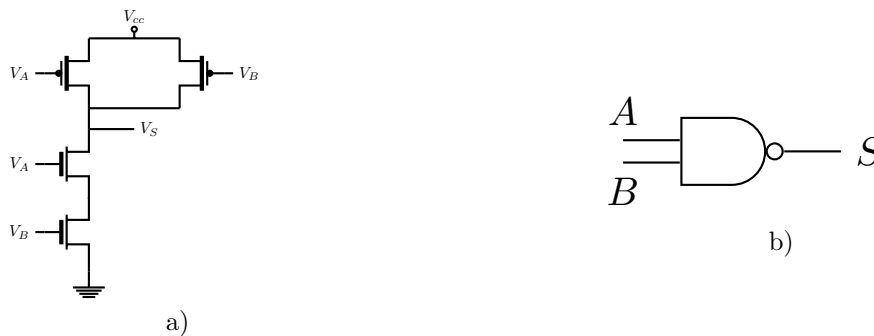
FIGURE 2.7 – a) Une réalisation possible d'une porte NAND en technologie CMOS avec deux paires de transistors PMOS et NMOS. b) Schéma abstrait d'une porte NAND. Sur ce schéma, on ne représente pas les tensions V_{cc} et la masse qui sont implicites.
