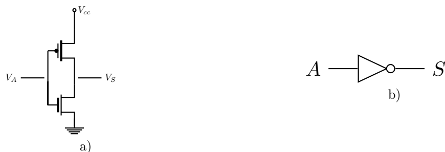
FIGURE 2.6 – a) Une réalisation possible d'une porte NOT en technologie CMOS avec une paire de transistors PMOS et NMOS. b) Symbole normalisé (norme Américaine) d'une porte NOT. Sur ce schéma, on ne représente pas les tensions V_{cc} et la masse qui sont implicites.
