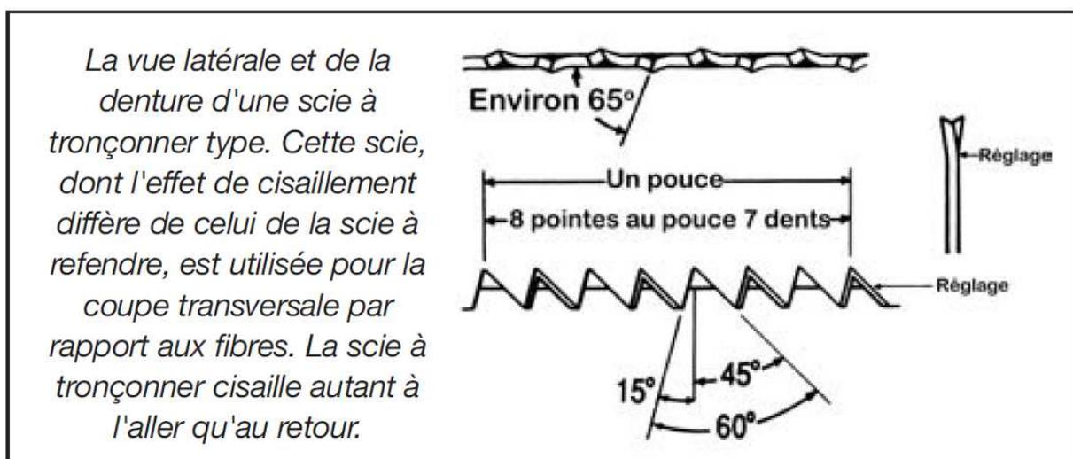
Pour la coupe du bois tendre, utilisez une 9 dents ou moins. Les dents évacuent facilement le bran de scie et empêchent le coinçage et le repoussement de la scie. Le sciage en long s'effectue à l'aide d'une scie à refendre.
