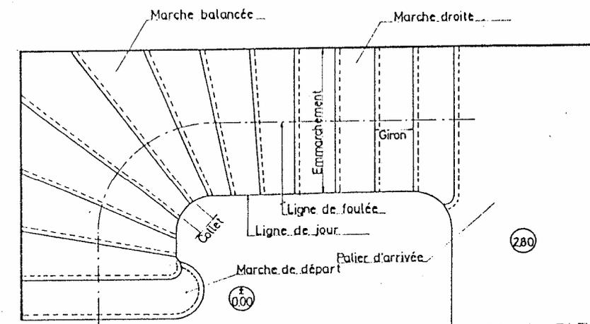
FIG. 2. - Vue en plan d'un escalier balancé.
