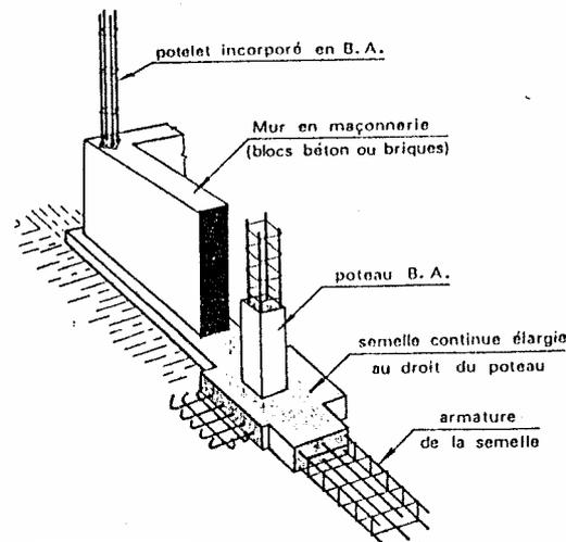
FIG. Armature d'une semelle continue sous poteaux B.A.
