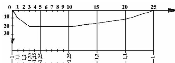
% d'eau en poids de sable sec déterminé par le séchage d'un échantillon de ± 100 g. ou à l'aide d'un appareil conçu à cet effet tel que le Speed, Moisture Tester.
