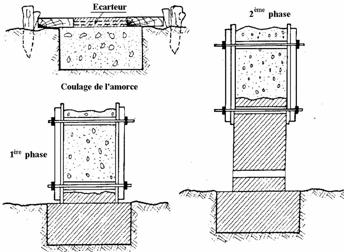
L'entretoise filetée peut être avantageusement remplacés par du fil de fer raidi à l'aide de tendeurs spéciaux dont la mise en oeuvre est plus aisée et rapide.
