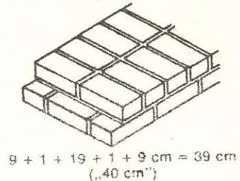
**-Exemple d'appareillage : appareil croisé :**
