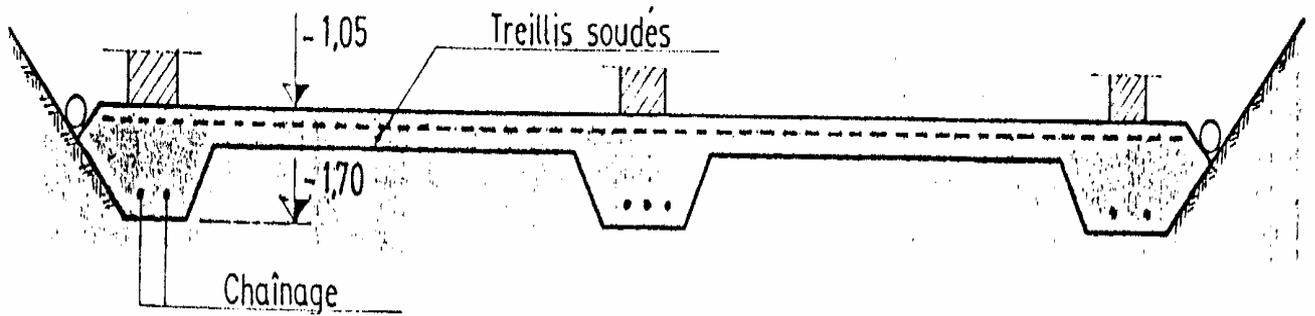
*La portance du sol doit correspondre aux charges à supporter pour permettre l'équilibre de la construction*
