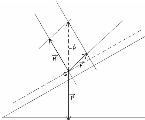
D'après l'échelle utilisée, on en déduit que  $F = 480\text{ N}$  et  $R = 620\text{ N}$
