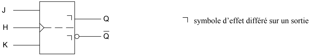
Figure 4 b – Symbole de la bascule JK maître-esclave
