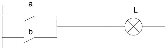
La lampe s'allume quand on actionne le commutateur a OU le commutateur b.
