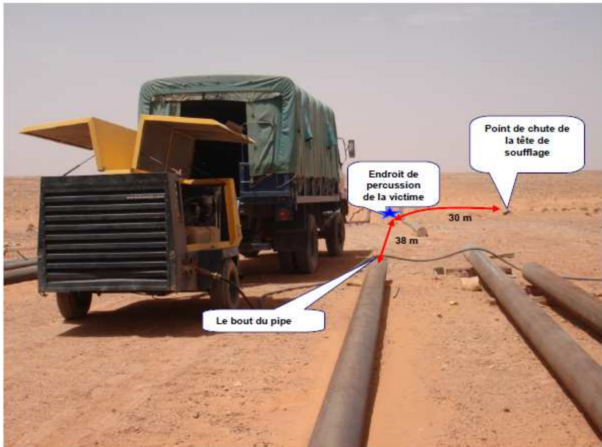
Figure IV-10. Circonstances de l'accident survenu suite à la négligence de certaines tâches de la procédure de travail du soufflage d'un pipe pétrolier du Groupe Sonatrach.
