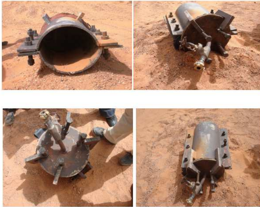
Figure IV-11. Différentes vues de la tête de soufflage après projection.
