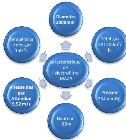
Fig.-III.4: Caractéristique de la cheminée IMAZA.
