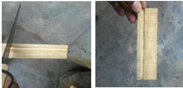
**Figure 55: Sciage du modèle P<sub>1</sub>**
