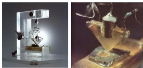
Figure 117: Transistor à contact
