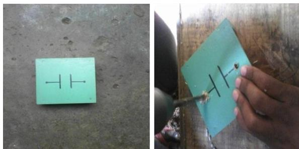
**Figure 97: Traçage du symbole de condensateur et perçage**
