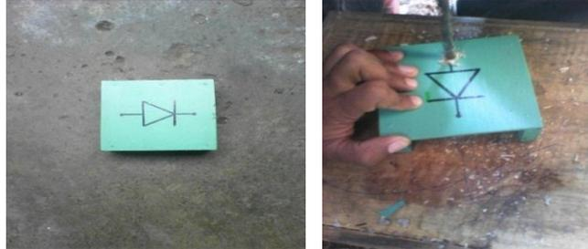
**Figure 72: Traçage du symbole de diode et perçage**
