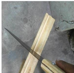
**Figure 93: Sciage du modèle P<sub>1</sub> pour le support de condensateur**
