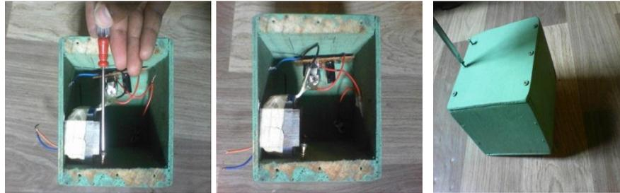
**Figure 112: Implantation du circuit imprimé et fermeture de la boîte**
