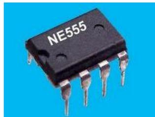
**Figure 43: Schéma du CI NE555**
