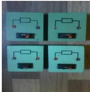
**Figure 62: Les 4 supports de résistor élaborés**
