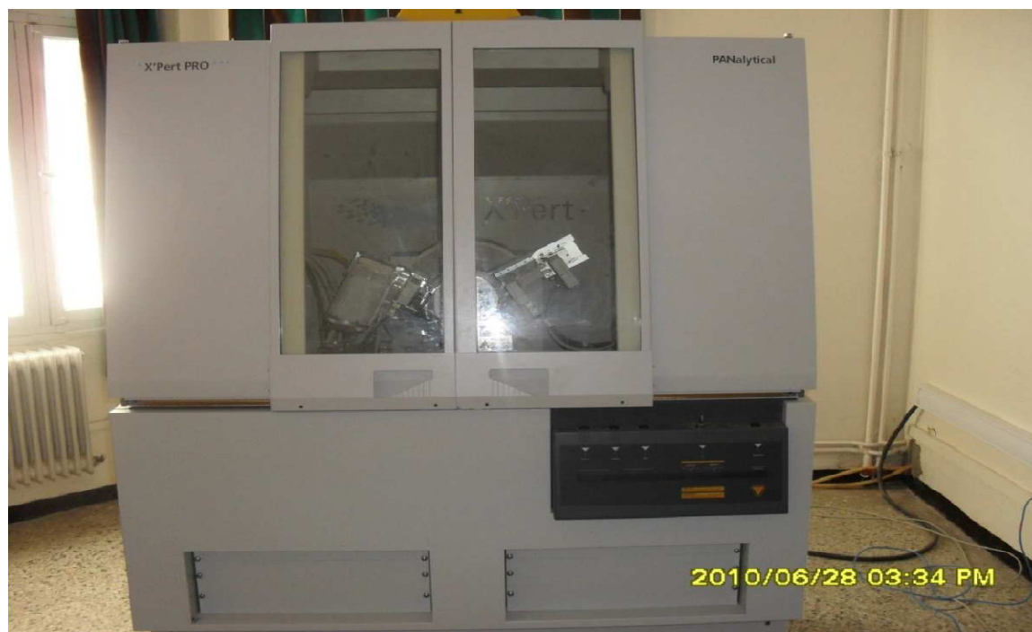
Figure. II.4.1. Diffractomètre utilisé pour la diffraction des rayons X
