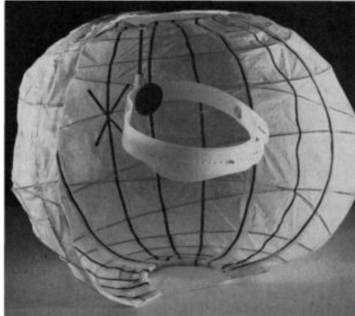
Figure 1. Dôme de conflit visuel porté par les sujets, afin de perturber les informations visuelles. (Shumway-Cook & Horak, 1986)
