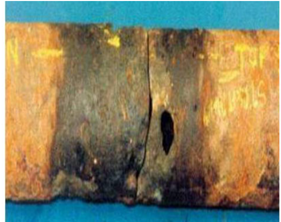
Figure I.9: Fuite dans une conduite d'eau potable [3] Figure I.10: Corrosion en réseau d'eau potable [4]
