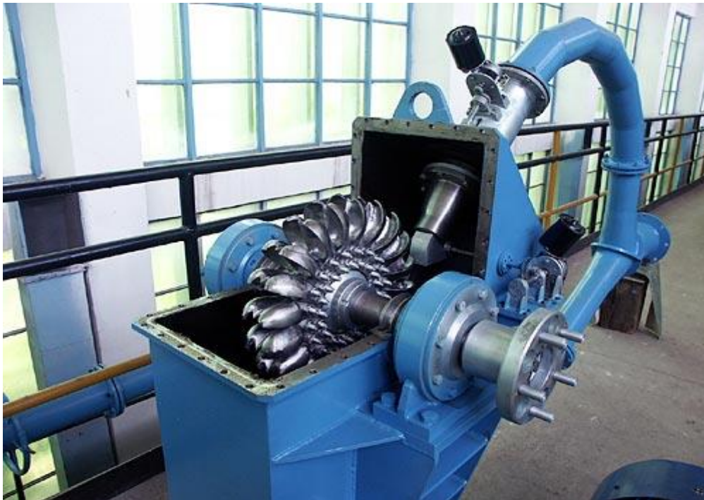
Figure III.4 Turbine à deux injecteurs [18]
