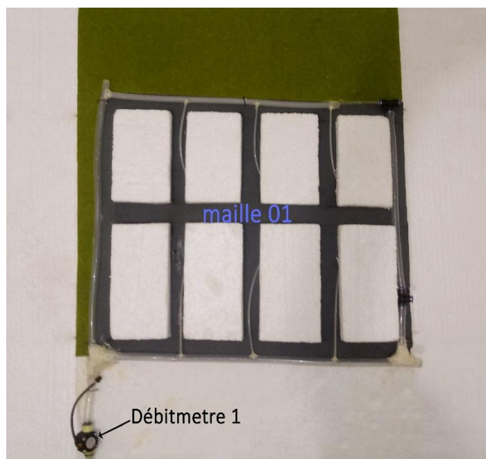
Figure 4.11 : première partie de réseau distribution (maille 01)
