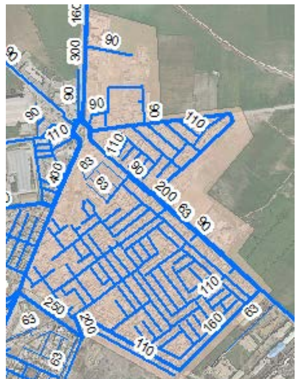
Figure III.16 : Réseau d'AEP du secteur 01
