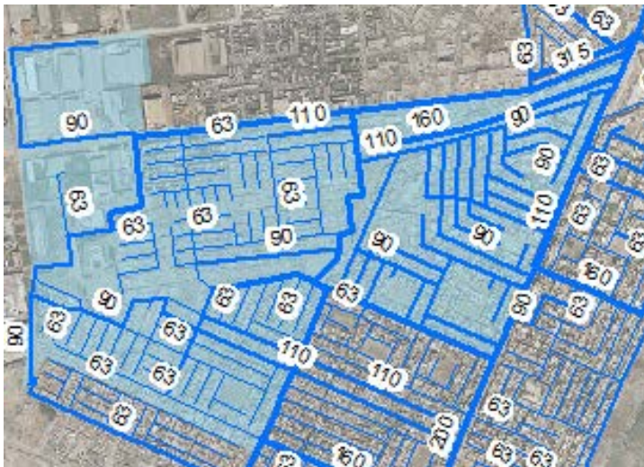
Figure III.21: Réseau d'AEP du secteur 03
