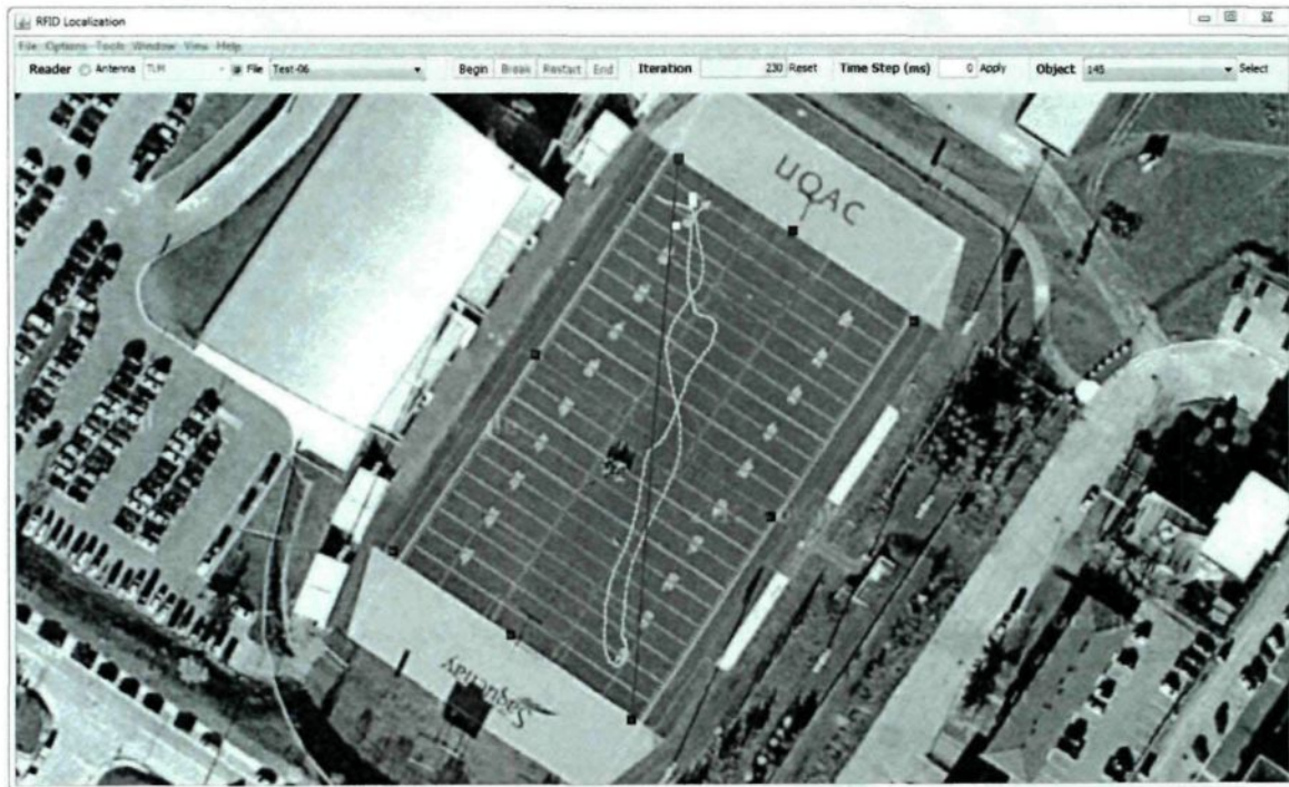
Figure 4.15 : Fonctionnement du système de localisation avec du matériel RFID actif en extérieur. Le trajet de référence est en rouge et le trajet calculé avec l'algorithme de positionnement est en jaune. Les carrés en bleu représentent des antennes RFID.
