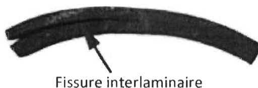
Figure 5-5 : Exemple d'une fissure indiquant une rupture en mode II.
