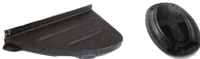
Figure 1-2 : Exemples de pièces en composites thermoplastiques pour l'industrie aéronautique. À gauche, une pièce de structure d'une aile d'avion [8]. À droite, la porte d'accès à la maintenance d'une aile d'avion [7].
