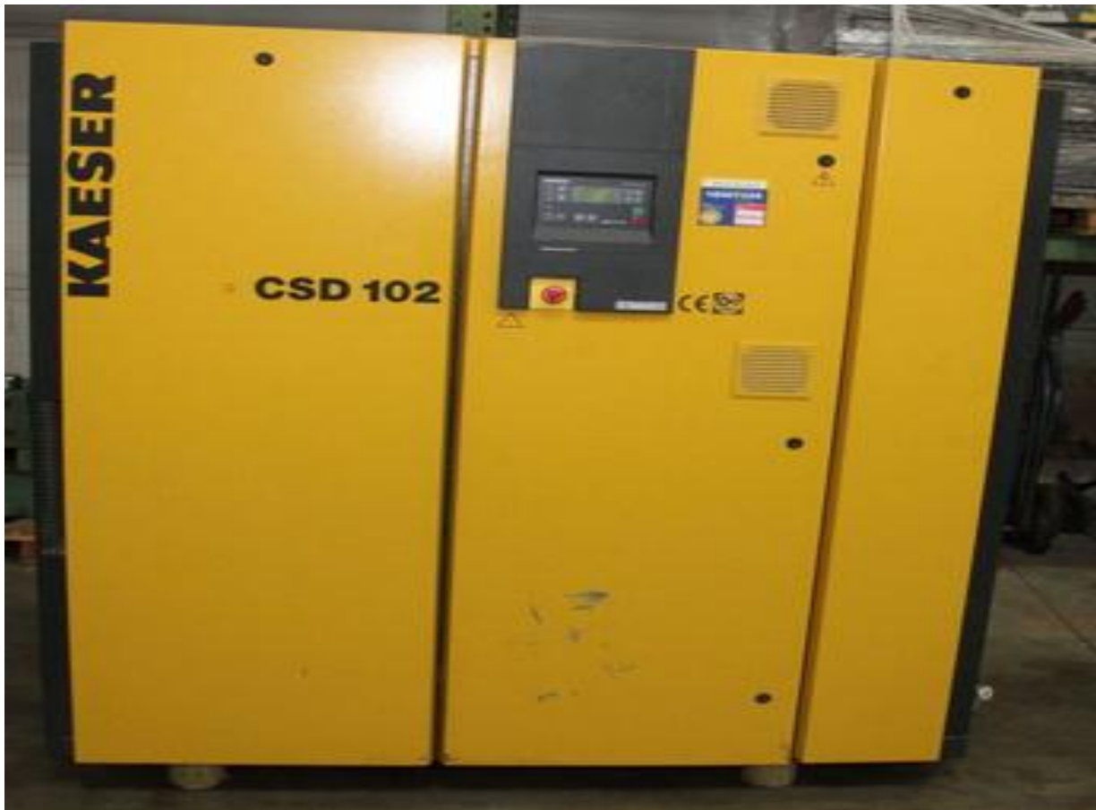
Figure 2.4 : un compresseur à vis KAESER CSD.
