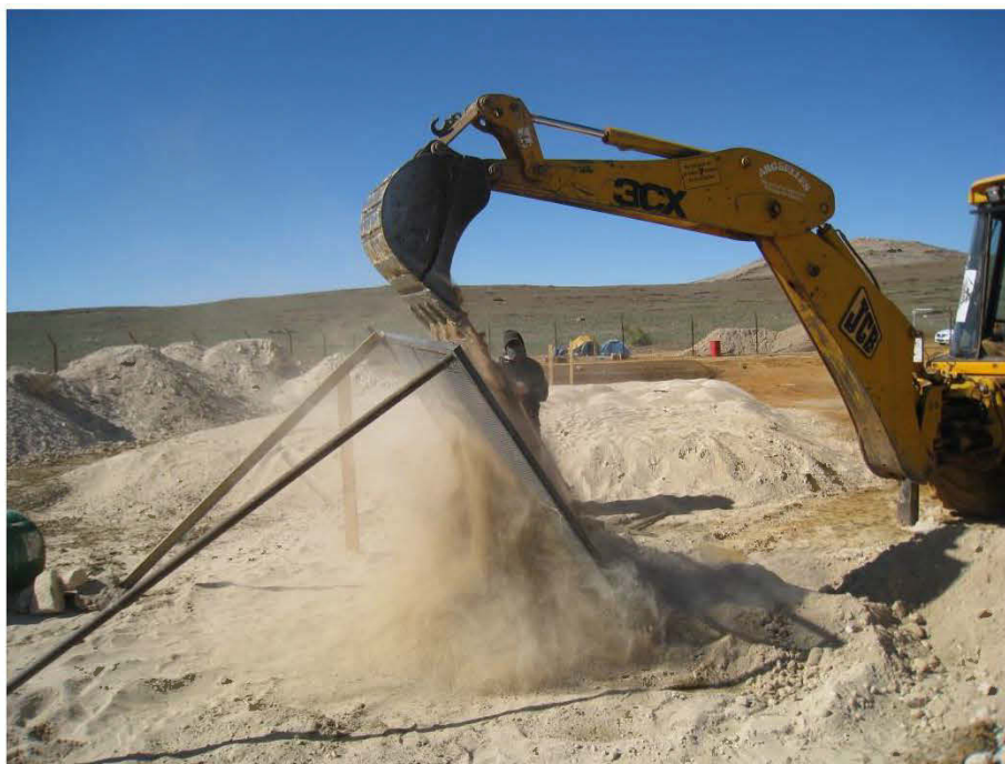
Figure G.11 Opération de criblage des rejets calcaires phosphatés.
