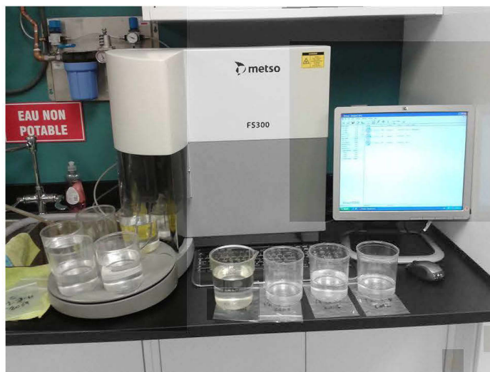
Figure 3.5 Analyseur de fibres Kajaani FS300 de Metso ®
