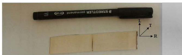
Figure 3.3 Exemple d'un échantillon utilisé pour les analyses densitométriques dans le densitomètre QTRS-01X Tree Scanner (QMS)
