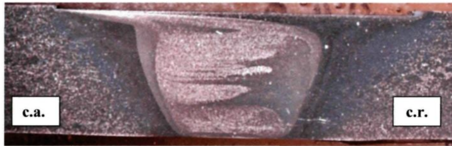
Figure 3 - Métallographie démontrant l'asymétrie entre le côté avançant et le côté reculant
