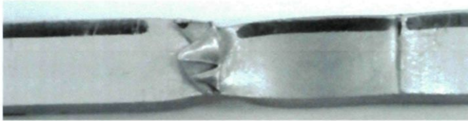
Figure 4.13 - Rupture d'un échantillon de soudage à l'endroit de la bavure
