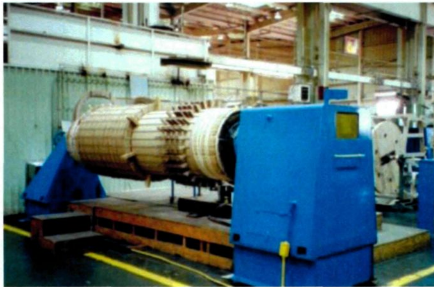
Figure 8 : Machine permettant de bobiner les transformateurs [23].
