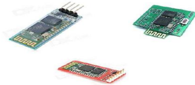
Figure(II.10) : Type de modules Bluetooth
