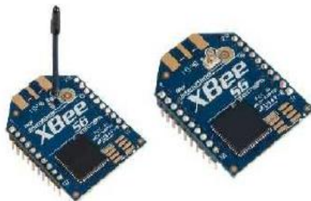
Figure(II.12) : Module Xbee
