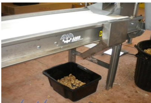
Figure 3.6 : table de triage inox alimentaire.[39]
