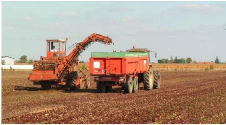
Figure 2.15 : Récolte avec une arracheuse trainée. [15]
