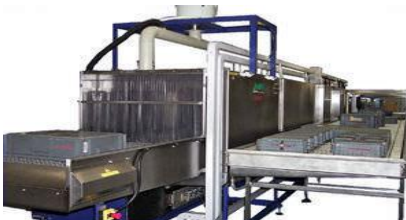
Figure 3.5 : Laveuse par aspersion.
