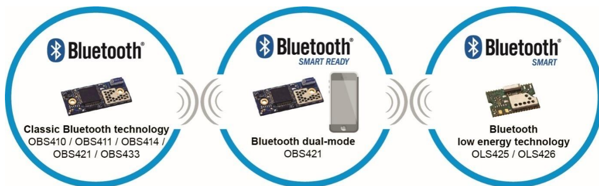
Figure 9: les différents types de Bluetooth utilisé pour la communication[1]
