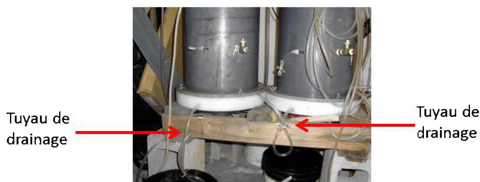
Figure 3-6 : Drainage des colonnes lors des essais
