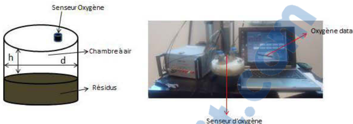
Figure 3-1 : Dispositif expérimental mis en œuvre pour les essais de consommation d'oxygène
