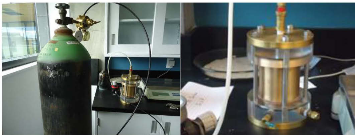
Figure 3-5 : Essais de rétention d'eau en cellule Tempe
