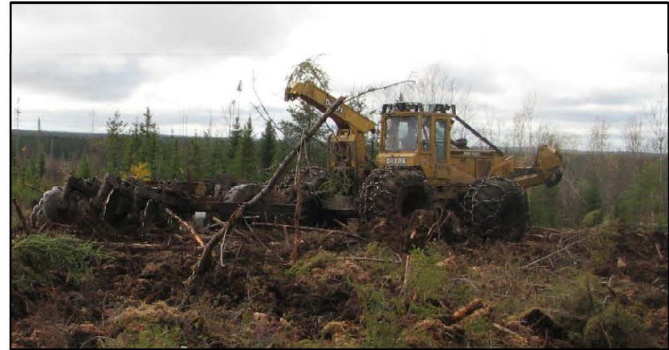
Herse forestière: machine multi-disques dentés, alignés en deux rangés. En Abitibi, elle est utilisée pour travailler les sols argileux et les terrains en friche (Manuel de foresterie, 2006).
