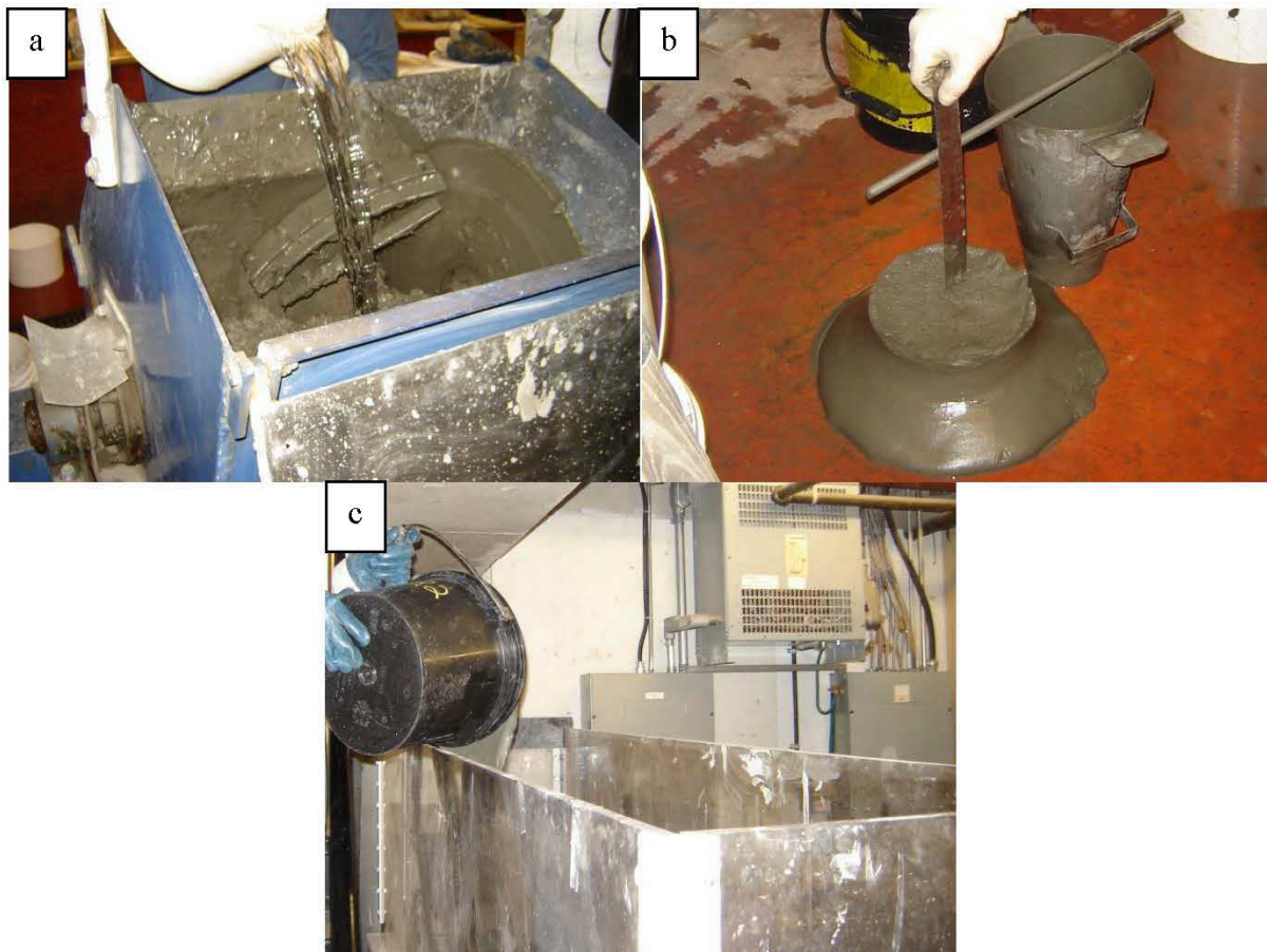
Figure 3-11 : Photographie de : (a) préparation de la pâte dans le mélangeur, (b) le test de l'affaissement et (c) le dépôt de la pâte dans le modèle physique.
