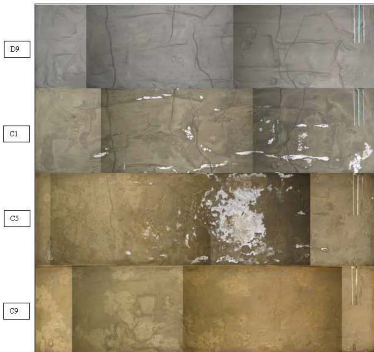
Figure 4-10 : Photographie montrant l'évolution de la surface de la couche 9 (couche supérieure dans le modèle physique), à la fin de la période de séchage, suivant le dépôt de la neuvième couche (D9), et à la fin du 1er, 5e et 9e cycle de mouillage/séchage (C1, C2 et C9 respectivement) (Deschamps 2009).
