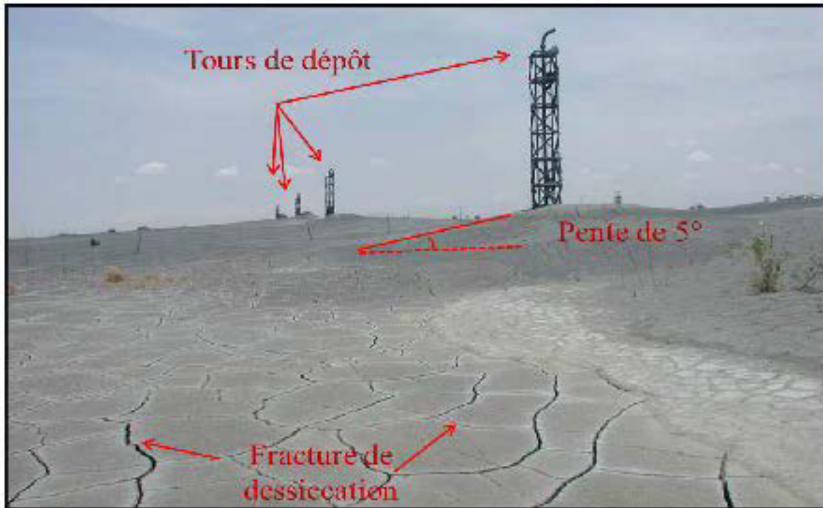
Figure 2-1 : Dépôt de résidus miniers en pâte de surface, à la mine de Bulyanhulu, Tanzanie (Photo Vincent Martin).
