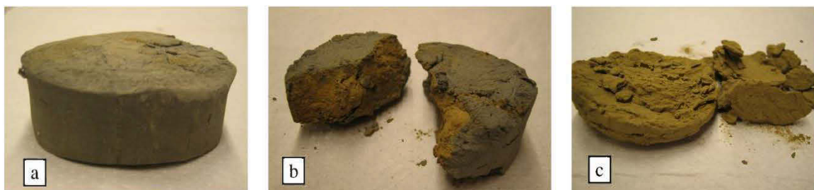
Figure 6-2 : Photographies des échantillons prélevés du modèle physique suite au carottage de 5 cm du diamètre : (a) exemple d'un échantillon du carottage, (b) exemple d'un échantillon du carottage montrant des chemins préférentiels d'oxydation, et (c) exemple d'un échantillon friable du carottage provenant de la partie supérieure du modèle (la partie oxydée) (Deschamps, 2009).
