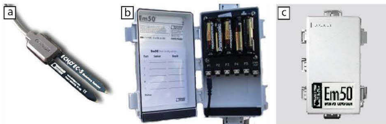
Figure 3-3 : Photographies (a) de la sonde ECH2O EC-5, (b) et (c) Le Décagone ECH2O EC-5.
