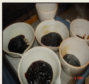
Mise sur plaque chauffante (humidité et cendre)
