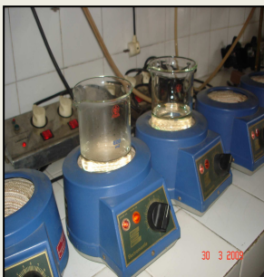
Chauffage de la solution sucrée après ajout du réactif de Luff_ Shoerl
