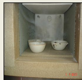
Mise dans le four à moufle (humidité et cendre)
