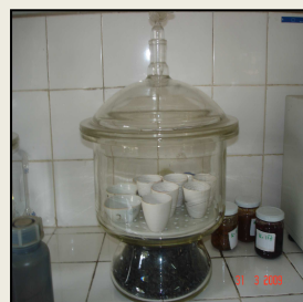
Refroidissement dans le dessiccateur (humidité)
