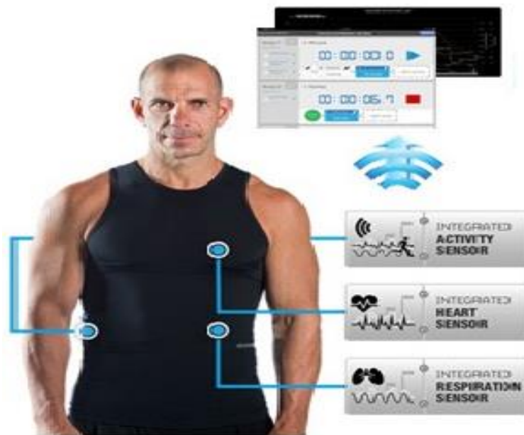
FigIII.4 –Tee-shirt intelligent contient un capteur d'activité, un capteur de pulsation cardiaque et un capteur de respiration cardiaque.
