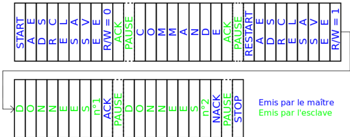
Fig IV.9 – Exemple d'échange de données entre un maître et un esclave.
