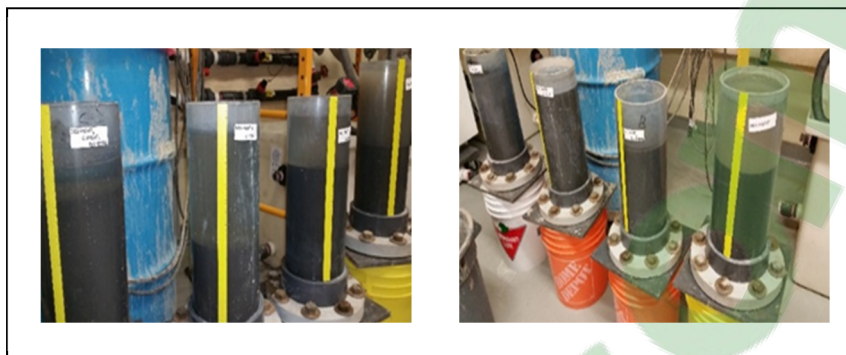
Figure 2-11. Filtration sur colonne
