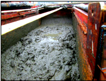
Boue décantée (Avant traitement)
