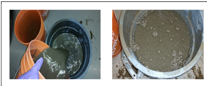
Figure 2-10. Opération de culbutage – Effet de floculation de boue
