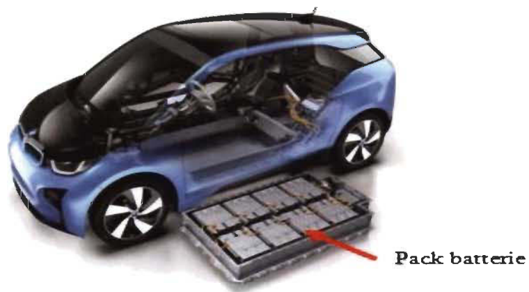
Figure 3. 11 : Pack de batterie pour VE [60].
