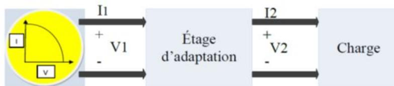
FIGURE II.1 – Étage d'adaptation entre un GPV et une charge.
