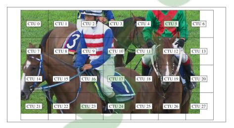
Figure 1.14 Partitionnement d'une trame HEVC de  $416 \times 240$  pixels en unités de codage arborescent (CTUs) de  $64 \times 64$  pixels
