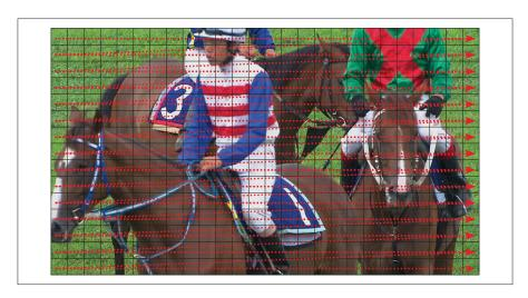
Figure 1.2 Partitionnement d'une image en superblocs de  $16 \times 16$  pixels
