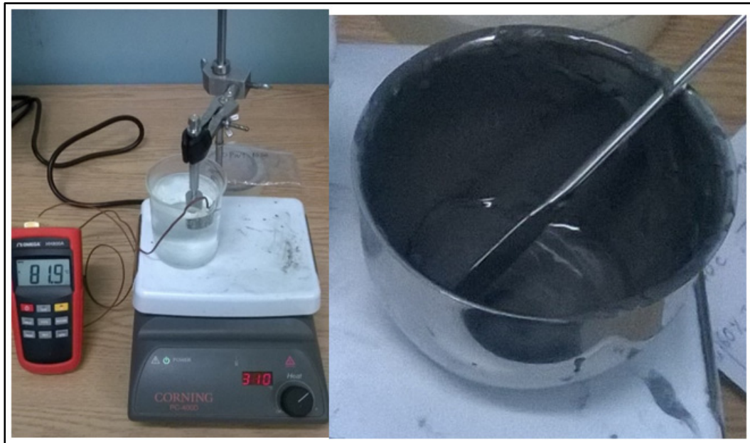
Figure 3.3 Préchauffage du cylindre "Bob" et du mélange poudre-liant
