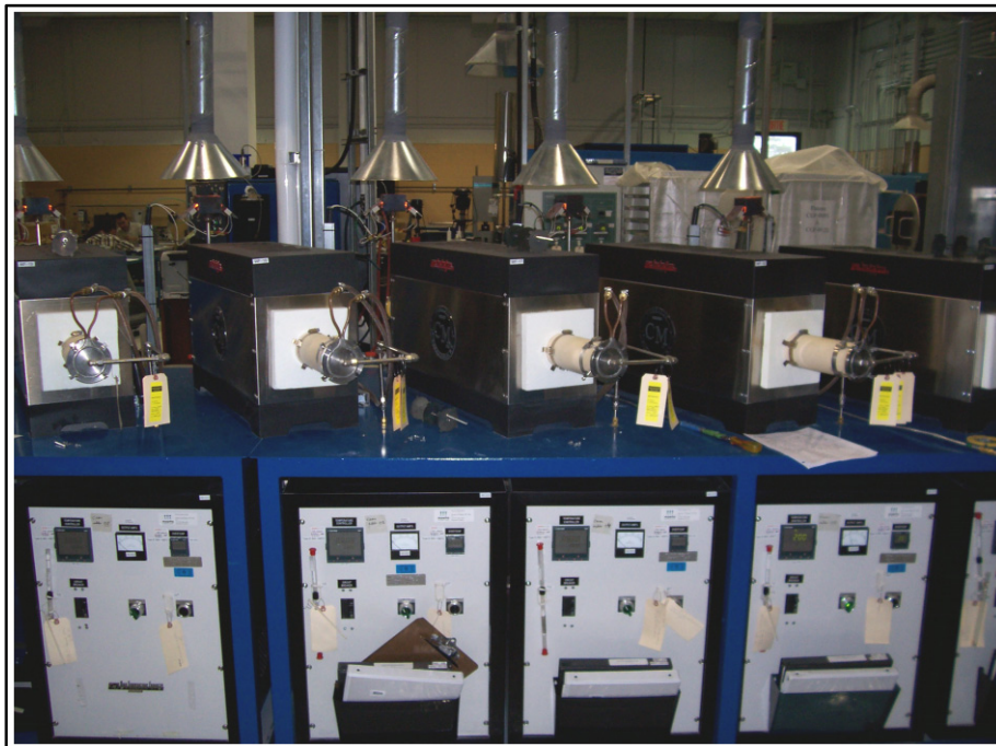
Figure 1.9 Photo des fours de frittage (Ste-Marie, 2009)
