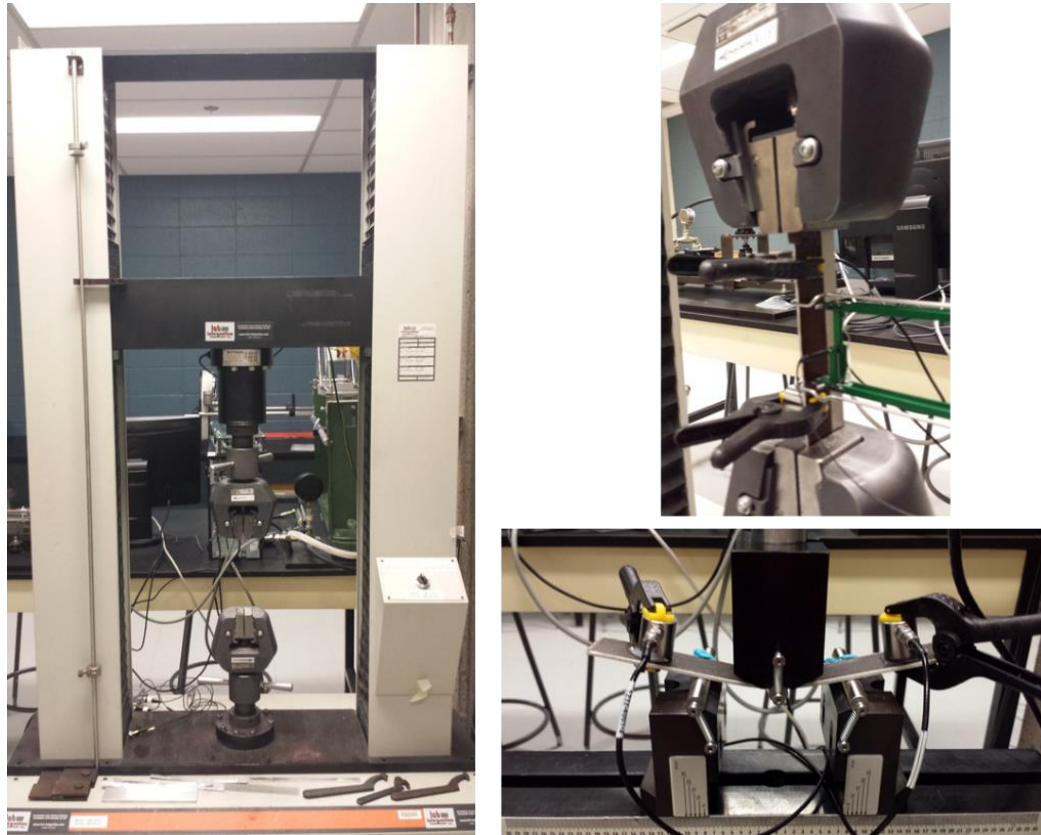
Figure 4.10: Essais de traction et de flexion d'un composite à renforts mats de lin et matrice époxy.
