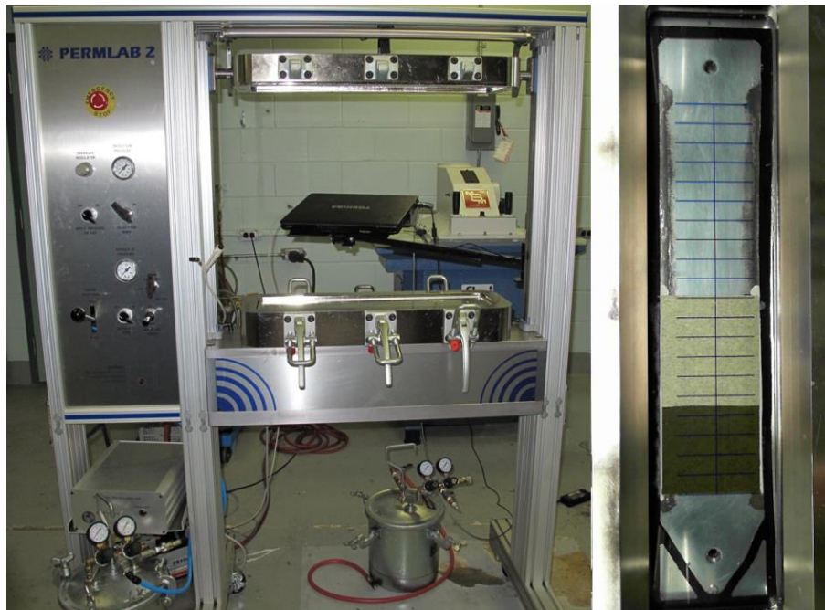
Figure 4.3: Montage de mesure de perméabilité (PERMLAB 2).
