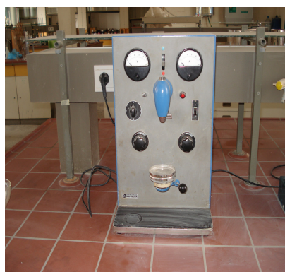
Photo 2: Electrolyseur, JANKE & KUNKEL. IKA-WERK.
