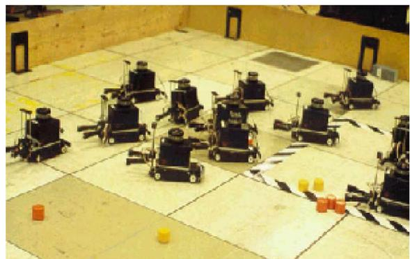
**Fig 3.5 bis** Ces robots, développés au MIT et baptisés « R1 », ont pour tâches de rechercher, de récolter et de rassembler les palets disséminés sur la table. Chacun est équipé d'une pince, d'un système de positionnement et d'un système de communication radio. Ils accomplissent cette mission collectivement : chacun profite des informations récoltées par les autres robots pour trouver les palets. MAJA MATARIC
