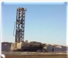
Foration : C'est une machine sondeuse destinée pour la foration des trous verticaux dans le sol disposés d'une façon bien déterminée, de telle sorte que l'on puisse utiliser des charges d'explosif a fin de sauter le terrain pour le rendre facile à décaper.
