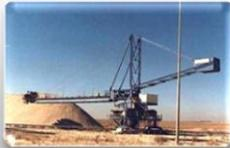
**Reprise :** Le phosphate stocké par la machine stockeuse est repris par une machine appelée Roue-pelle.
