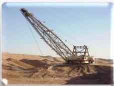
**Décapage** : C'est l'enlèvement des terrains morts pour accéder aux couches phosphatées au moyen de grande machine appelée dragline.
