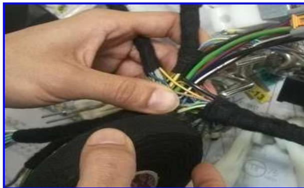
**Figure 4.13 : Etat avant amélioration des fixations des fils**
