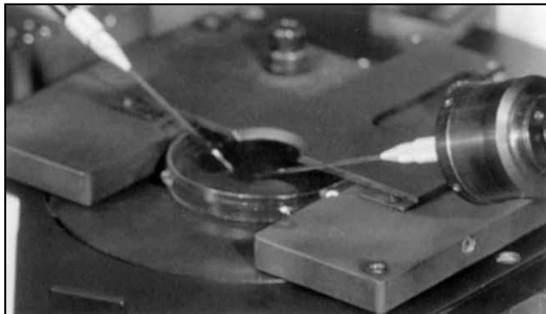
Figure V.2. Vue supérieure proche d'une partie de microscope montrant la plaque métallique électriquement chauffée sur laquelle la boîte contenant les gamètes est placée (Godwin, 2004).
