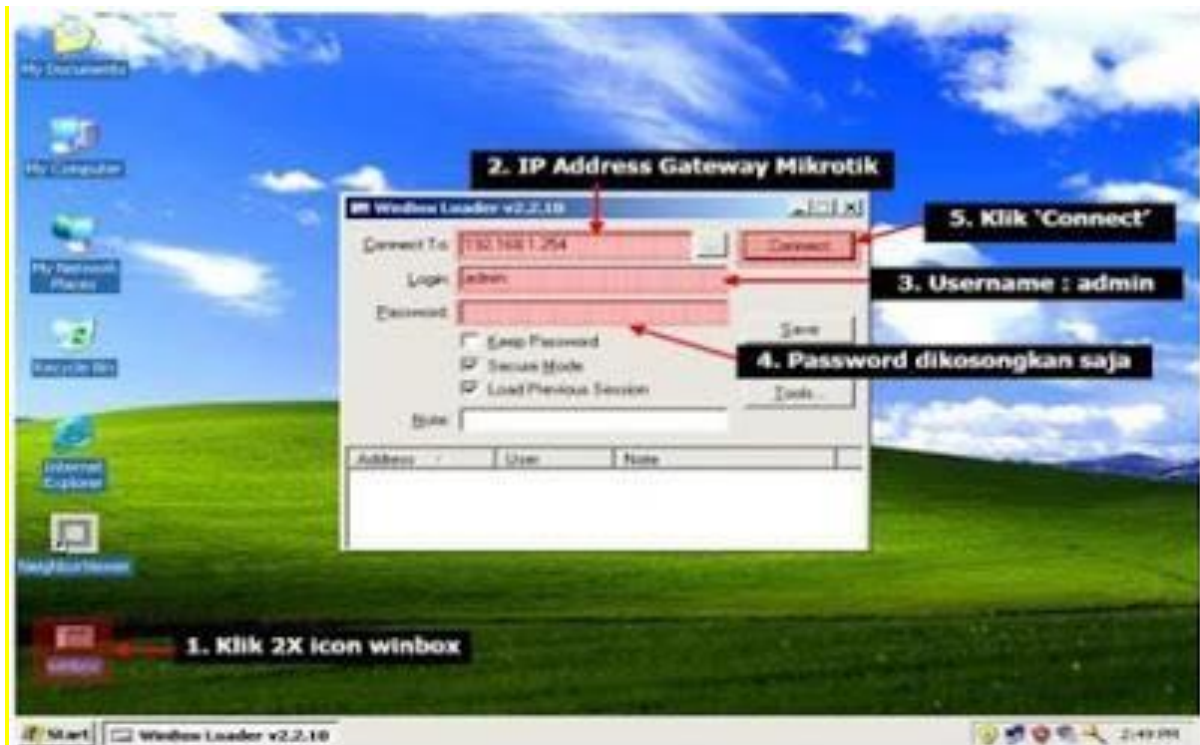
Figure 30 : connexion au routeur via winbox
