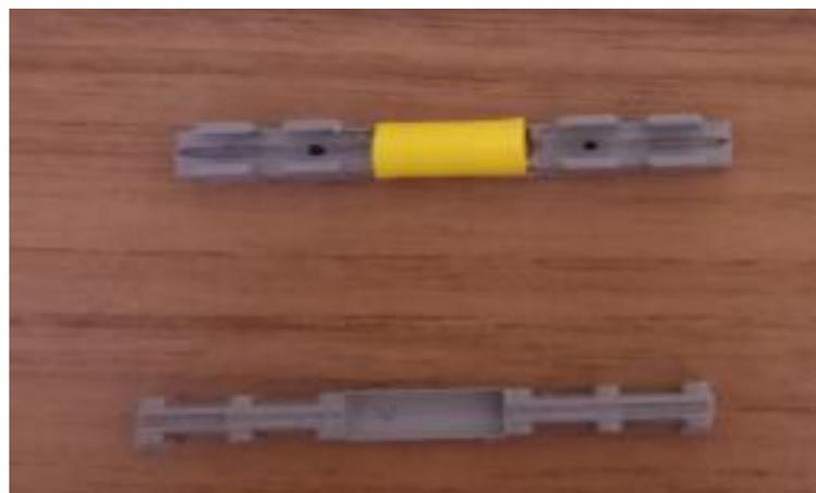
**Figure III.33 : Etape « 2 » de l'épissure mécanique**
