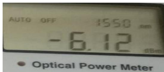
**Figure III.10** : puissance reçue sur le wattmètre optique
