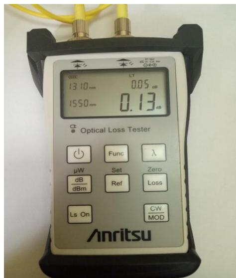
**Figure III.6 : Mesure de pertes optique**
