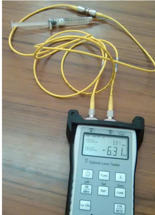
**Figure III.13** : Mesure de la puissance reçue à l'aide de la source laser/testeur de pertes
