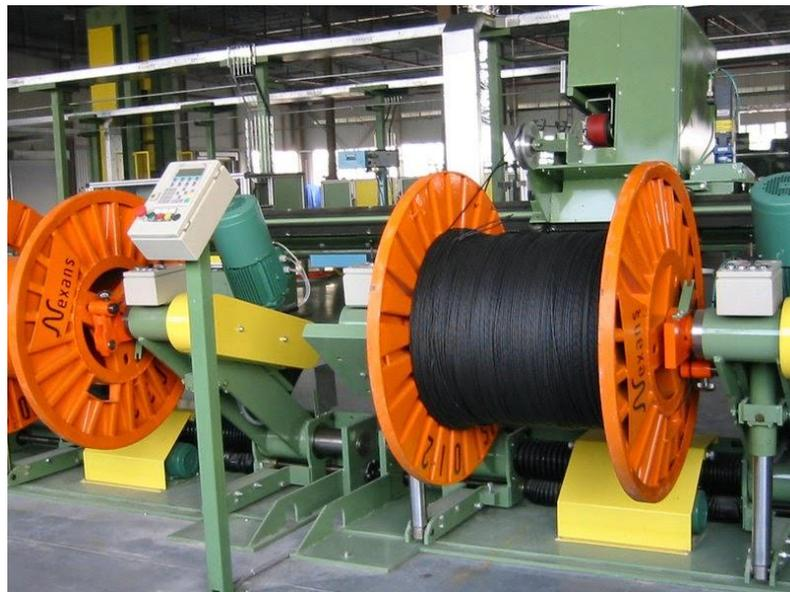
**Figure II.2 : 2<sup>ème</sup> étape de fabrication (le fibrage)**
