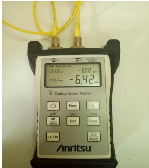
**Figure III.5 : Mesure de la puissance reçue**
