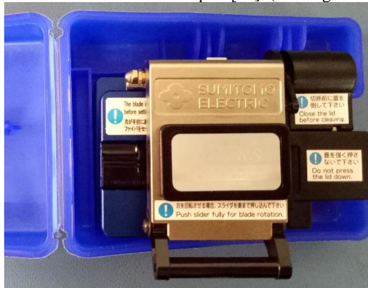
**Figure III.19 : Cliveuse FC-6RS-C de Sumitomo**
