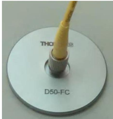
**Figure III.36** : Disque de polissage D50-FC de thorlabs
