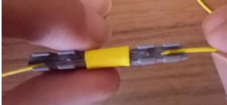
**Figure III.34** : Etape « 3 » de l'épissure mécanique
