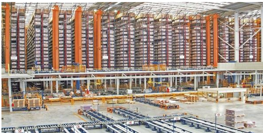
Figure 1. 8 : AS/RS à charge unitaire
