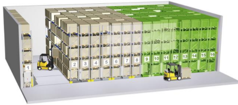
Figure 1. 10 : AS/RS à rack glissant
