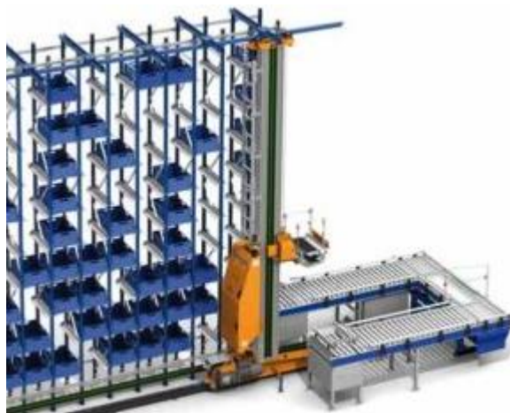
Figure 1. 7: une station de dépôt/livraison P/D
