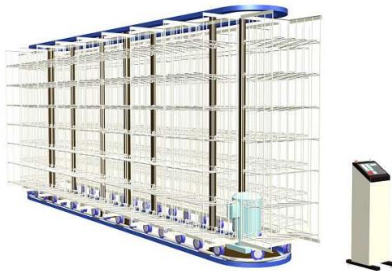
Figure 1. 12 : AS/RS à carrousel
