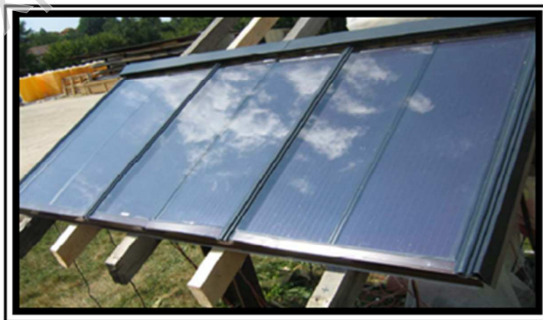
Figure 3-15: Le capteur solaire PV/T hybride à eau [2]
